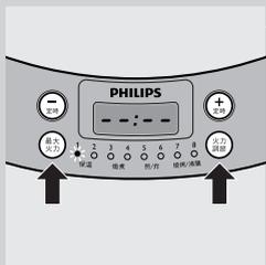
**3** 待機狀態下按最大火力、火力段數調整鍵進入加熱狀態。
