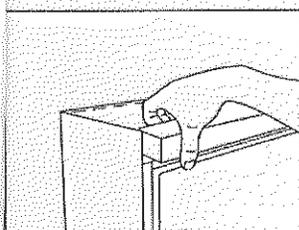
4. 向前傾斜移開頂板 (有三個固定處)。
