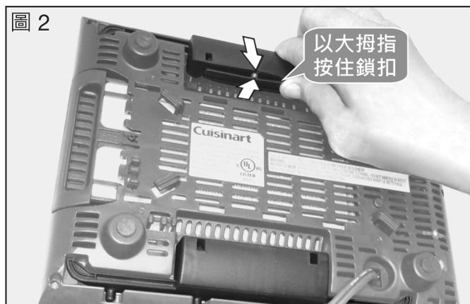
3D. 當大拇指仍緊緊地按住鎖扣時 , 將把手向上提 (如圖 - 3 中黑色箭頭所指方向) , 即可將面板自麵包機的底部取出。
