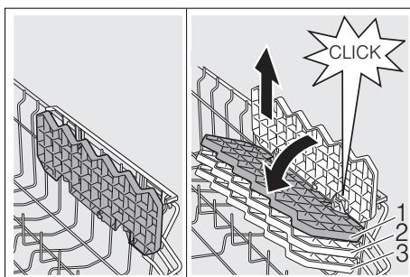
\* 部分機型可調節 3 種高度。此時，請先將疊架拉直並向上拉，然後稍微傾斜向下推到所需高度 (1、2 或 3) 並讓疊架入孔，此時應聽到哢嚓聲。
