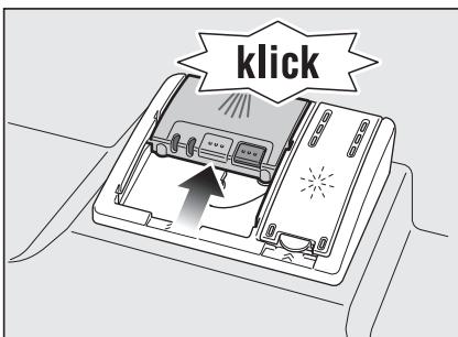
洗滌劑槽依洗程需要，將會在最佳時刻自動打開。粉狀或液體狀洗滌劑會在機器中分散並溶解，碇狀洗滌劑會掉入洗碗碇槽中並在那裡逐漸溶解。
