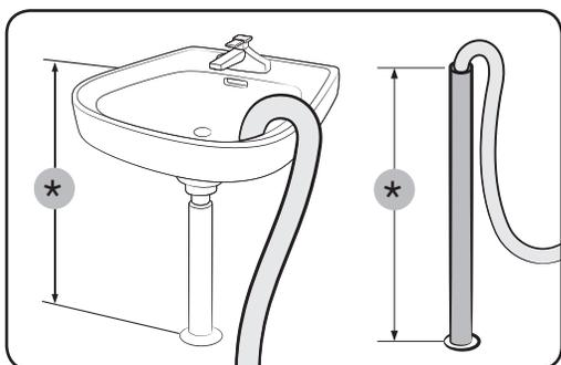
2. 將排水管的另一端連接到距離地面 90-100 (\*) 公分的豎管或洗手槽。
