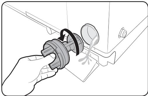
1. 在泵濾網下放置拖地布或毛巾。以逆時針方向旋轉濾網以將濾網取下。
