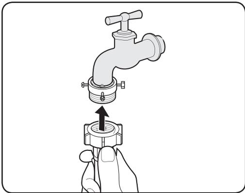
4. 向上垂直按壓進水管，使水管內的橡膠密封件能夠完全貼合水龍頭，然後透過向右侧擰緊進行緊固。
