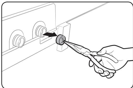
1. 使用鉗子將進水過濾網依圖示從進水口中夾出。
