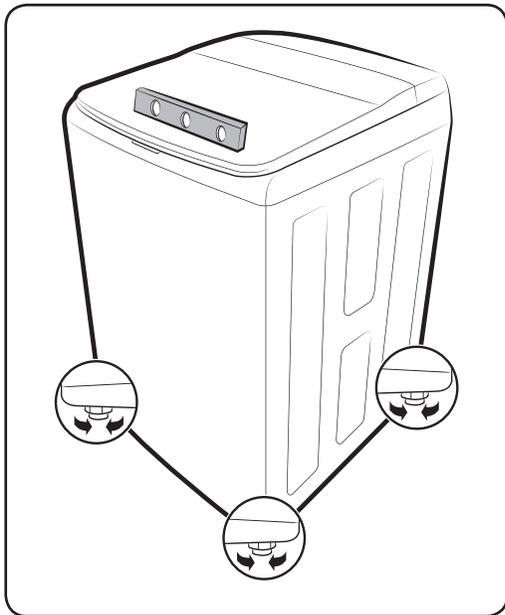
4. 若洗衣機放置不平衡，根據需要順時鐘或逆時鐘旋轉平衡支腳進行調整。
