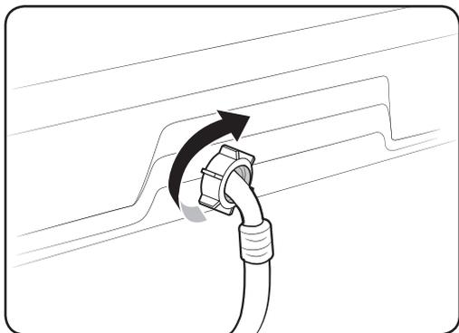
6. 將水管的另一端連接至洗衣機背部的進水閥。順時針方向旋轉軟管以擰緊。
