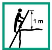
直梯架設在屋頂、屋平面處時，支撐點需超過1米
