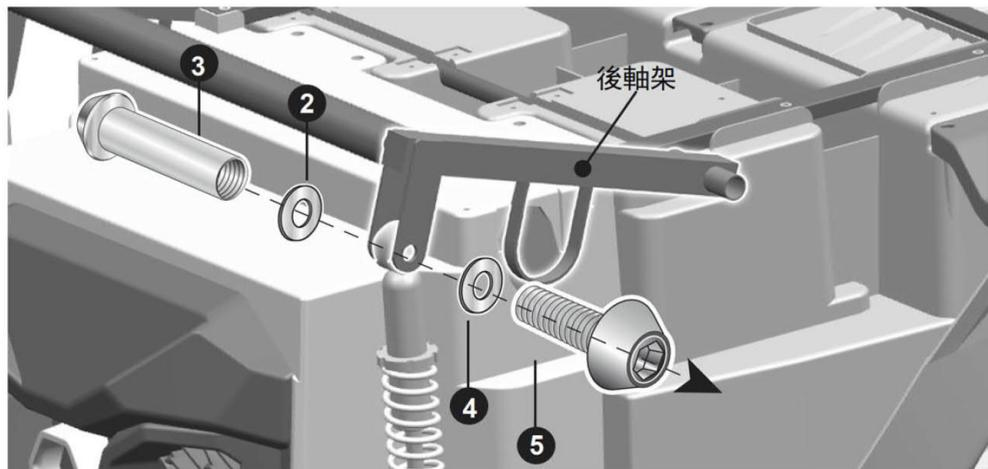
翻轉車身，使其背面朝上；用尖嘴鉗剪去後軸架上捆綁電機的紮帶，鬆開電機，注意不要撥下插件。
