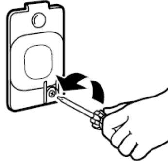
3. 將燈泡依反時針方向轉動並拆下。僅可使用 10 W 之家電用燈泡作替換，裝回上蓋並以螺絲將它固定妥。
