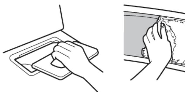
每次放入衣物烘乾之前，請先清潔棉絮濾網。將棉絮濾網從固定槽往上拉出，以手指將棉絮捲起，切勿將它以水清洗或洗滌方式清除棉絮。將濾網重新裝回至原處。
