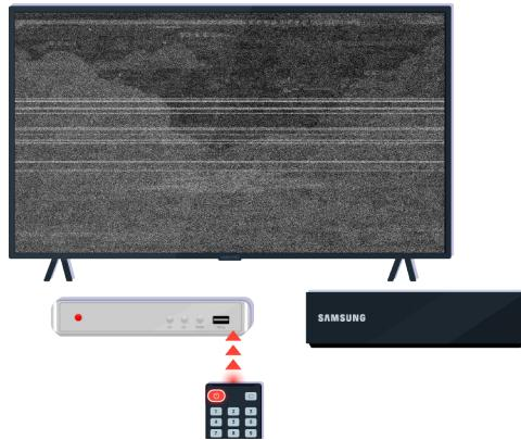
如果使用多品牌遙控器 (MBR) 或通用遙控器，而您的遙控器無法操作外部裝置時，請將外部裝置移近 One Connect Box。
