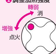
將開 / 關旋鈕朝向「點火」的位置轉動，就可以提高加熱強度，而朝向「消」的位置轉動則可以降低加熱強度。
