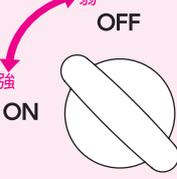
將開 / 關旋鈕朝向「ON」的位置轉動，就可以提高加熱強度，而朝向「OFF」的位置轉動則可以降低加熱強度。
