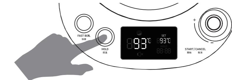
※當設定的保溫溫度低於現在水溫時，保溫模式會在溫度降至設定溫度時起動。
