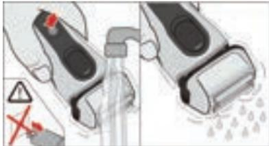
**2** 接下來，關閉 (OFF) 電源開關，按下刀頭刀網卸除鈕 ②，取出刀頭刀網 ① 風乾。
