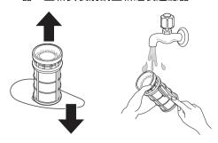
4 若要更換組裝好的過濾器,請放好噴灑器,這樣就會有朝向前方的V字形空間。將過濾器重新安裝在過濾器支架並加以固定時,只要順時針轉動內部過濾器並扣至定位即可。
