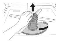
**3** 使用柔軟刷子在流動的水下方清潔過濾器。重新安裝前請重新組裝過濾器。
