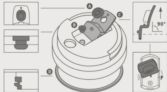
**D 矽膠密封圈：**杯蓋下緣矽膠密封圈可拆卸清潔，安裝時請參考圖示，留意密封圈的安裝位置和方向，避免造成滲漏。
