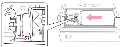
進行安裝時，請確定磁鐵和瓦斯罐之間沒有空隙。
