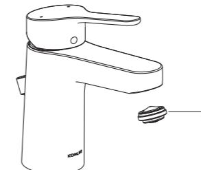
用硬幣拆下起泡器組件(26)。打開水龍頭冷熱水，讓水流出約一分鐘以清除雜質。沖洗起泡器組件，關閉龍頭，重新裝回起泡器組件。
