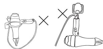
電線保護套與電線勿呈現垂直彎折
