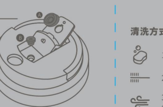
**B 止水矽膠塞：**於杯蓋撥片上中間位置附有可拆卸止水矽膠塞，拆除時，請由杯蓋內輕拉拔出，因體積較小，請留意清潔後晾乾，安裝時，請於杯蓋上方輕壓，即可完成安裝。
