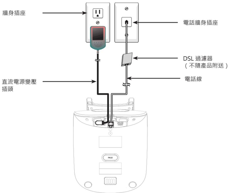
1. 如圖所示，把電源變壓器的直流插頭和電話線一端插入主機。
