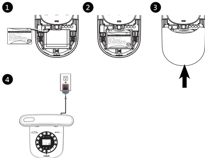
1. 滑開電池蓋。插上電池連接線，如圖所示。
