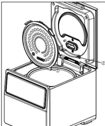
※ 清洗時依照圖示取下內蓋，內蓋可以直接浸泡清洗，勿再做細部分解，避免破壞其組裝架構！
