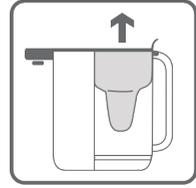
· **安裝水箱：**安裝時將水箱從上往下裝入，確保水箱與機器下方凹槽定位並將背面卡扣加以固定。若水箱未安裝正確，缺水提醒指示燈會持續閃爍。
