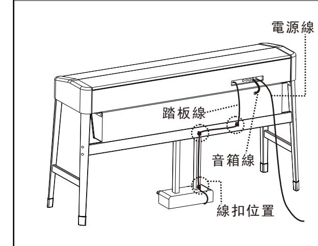
將踏板線及音箱線分別插入相應端口上，用3個夾線扣將踏板線固定在琴身上，防止移動琴體時壓壞連接線，取出電源線，插入電源接口上。
