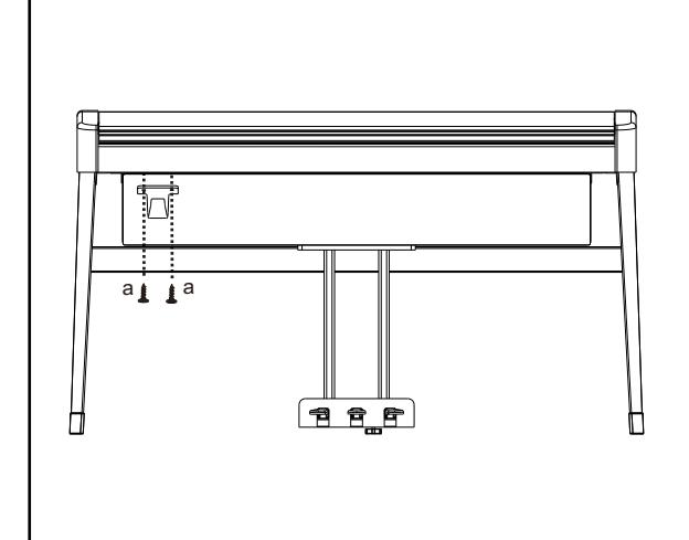
在配件袋中取出耳機挂鈎，用2顆a螺釘把耳機挂鈎固定在部件①底部，安裝孔在琴體左前方底部。
