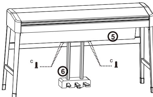
部件⑥連接線取出放置一旁，用4顆c螺釘將部件⑥安裝固定在部件⑤底部。
