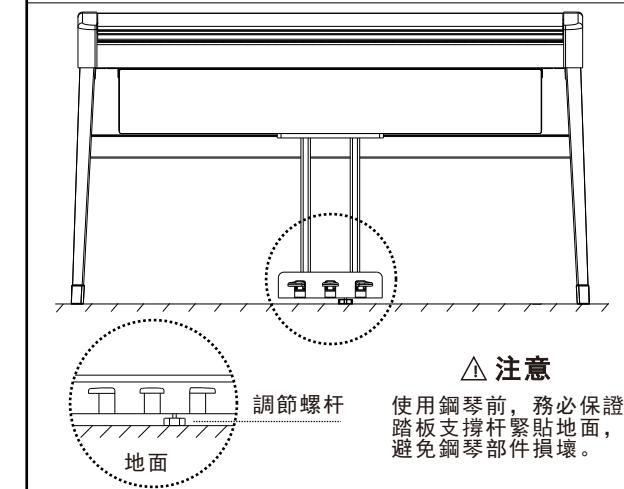
將琴體移動到擺放位置後，順時針旋轉踏板調節螺杆，使螺杆底部緊貼地面，防止踩踏板時造成踏板損壞。(踏板調節螺杆位於中踏瓣)
