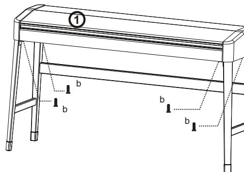
將部件①放置在組裝好的琴架上，調整位置使兩部件安裝孔位對齊，並用4顆b螺釘固定。
