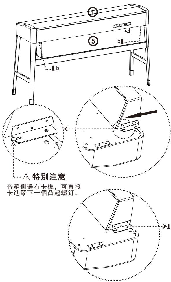
將部件⑤由後往前放置，與琴體底部的安裝孔位對齊，用2顆b螺釘將部件⑤固定在琴體底部(音箱連接件卡槽與琴體底部定位螺釘對齊，音箱由後往前推入)。
