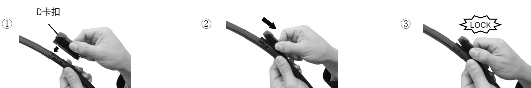
如何移除舊雨刷 How to remove old wipe
