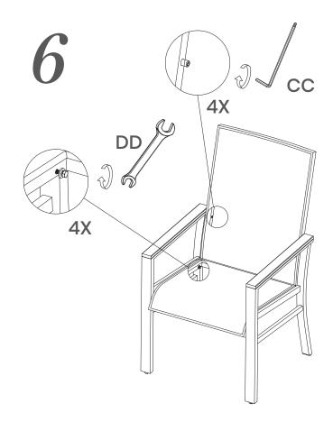
注意:將產品正確定位後,確保四個腳都平放在地面上,然後使用扳手擰緊螺栓。
