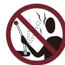
在確保正確安裝或拆卸前，請在處理任何負載杆時務必小心。請確保面部遠離負載杆。杆子安裝不當可能會脫離並導致面部受傷或失明。
