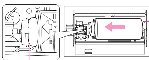
進行安裝時，請確定磁鐵和瓦斯罐之間沒有空隙。
