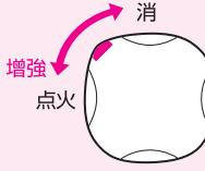
將開 / 關旋鈕朝向「點火」的位置轉動，就可以提高加熱強度，而朝向「消」的位置轉動則可以降低加熱強度。
