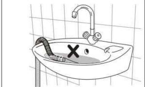
採用這種方式時,請確保出水端不會在洗 衣機排水過程中脫落。要做到這一點,可 將排水軟管繫在水龍頭上或固定在牆上。
