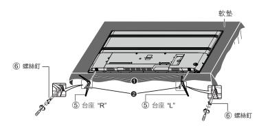
步驟 1 将支架配插入顯示器底部的开口中。
