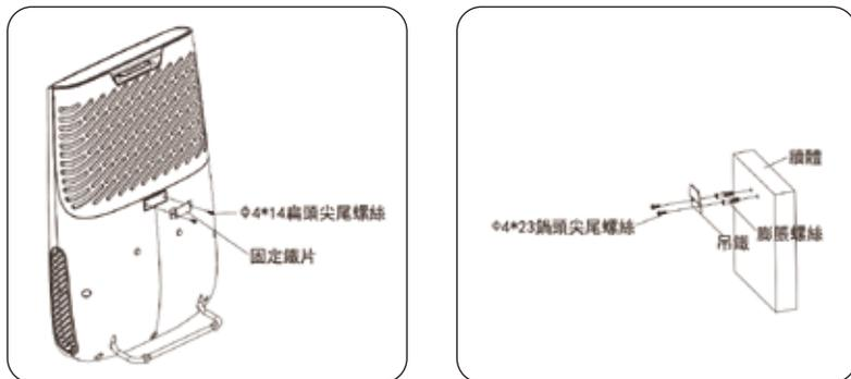
a 固定鐵片的安裝方式
