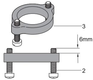
2. 將螺釘(2)旋進安裝環(3),直到螺釘露出安裝環6mm。
