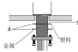
3. 將墊片(4)安裝到牙管(5)上,安裝環旋到牙管上。
