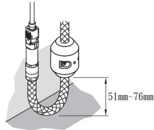
9. 如圖所示,調整重錘到合適位置並鎖緊固定。
