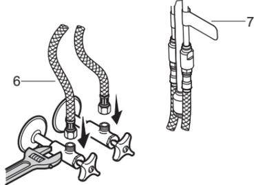
5. 連接並所緊軟管(6)到水源上。貼“COLD”標籤(7)的軟管連接冷水。
