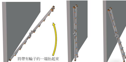
從小 A 字梯狀態開始：打開和鎖定您的工作梯呈一字型，並將工作梯正面朝上放在地面上。拉開固定鎖，先延伸上外梯；上外梯必須完全展開，才能展開下外梯。（如果您的工作梯有輪子，輪子必須放在一字梯的上端。）一旦延伸外梯至想要的高度，鎖住固定鎖。一定要重複檢查，確定兩個角鍊與四個固定鎖都完全鎖住扣緊。
