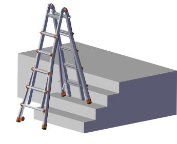
從 A 字梯的狀態降低其中一邊梯架一個踏階高度。請確保工作梯架置在平坦的表面上，而且短邊的梯架必須倚靠穩固的牆面上。
