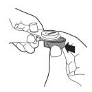
8 將自動奶泡機安裝至奶泡機上蓋。 聽到喀噠聲,表示兩個零件安裝到位。
